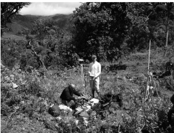
Figura 4 – Instalación e inicialización del DGPS (según J. Y. Bigot)
