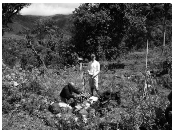
Figura 4 – Instalación e inicialización del DGPS (según J. Y. Bigot)
