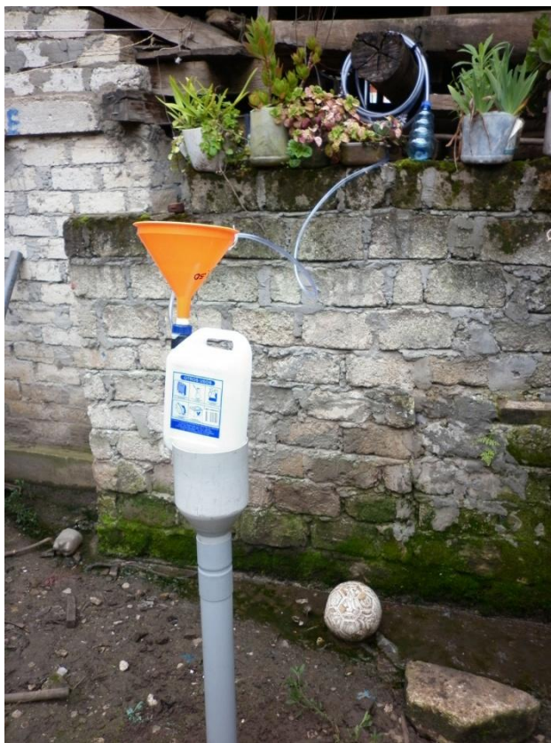
Colector de agua de lluvia para el análisis de isotopos de Oxígeno fuera del ambiente de la caverna
