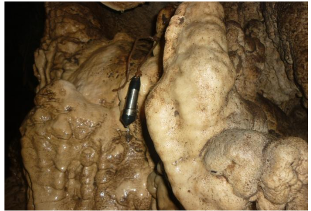
Instalacion del dripletger de goteo rápido y el Baro para la monitoreo dentro de la caverna
