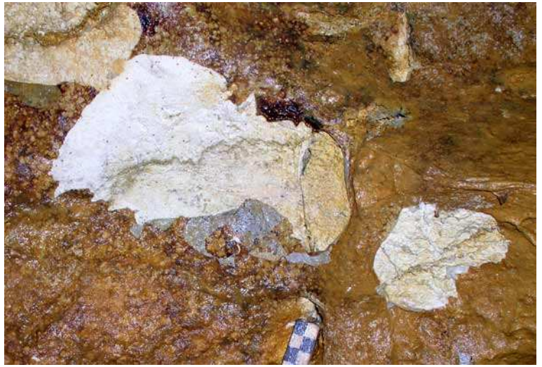
Figure 3 : Film bactérien recouvrant le calcaire altéré (blanc vert).
